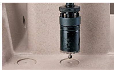
B - Posizionare la fresa in corrispondenza del preforo
