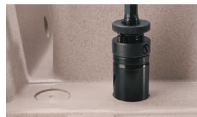
C - Procedere con il completamento del foro
